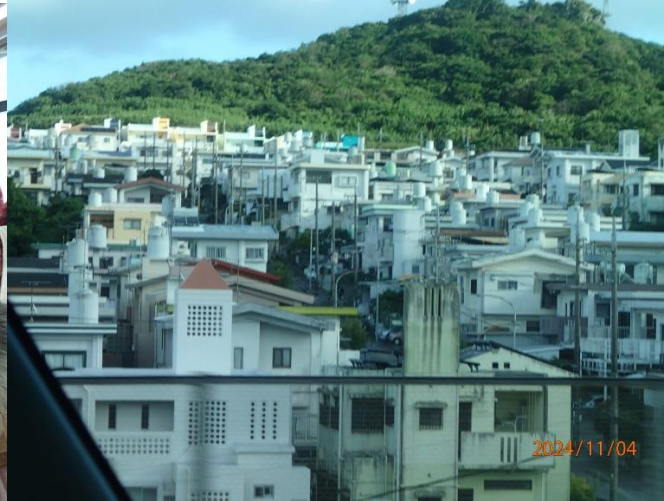
沖縄の住宅街。木造は少なくコンクリート造りが多い。 台風の風速 60m/sec に耐えるためには、強固でなくてはならないとだろうと納得する。
